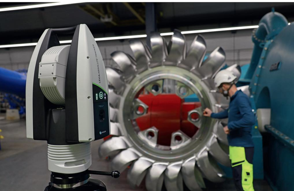
1 Die Laser-Tracker-Plattform Leica Absolute Tracker AT500 ergänzt mit der handgeführten und akkubetriebenen B-Probeplus eine taktile Messfunktionalität © Hexagon
