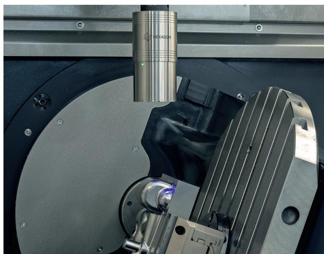
3 Ob Wanddickenmessung oder Maschinenkalibrierung: schnelle, genaue und datenreiche Messungen können auch direkt in der Maschine erfolgen © Hexagon
